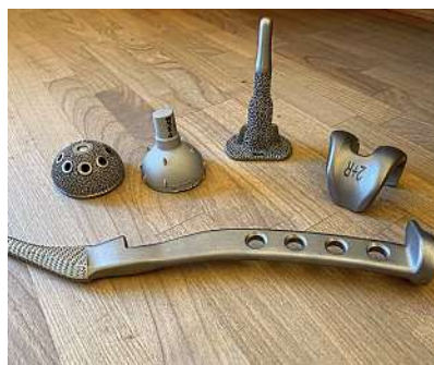
Pièces finies réalisées par Medimet, parmi lesquelles un cotyle de hanche
