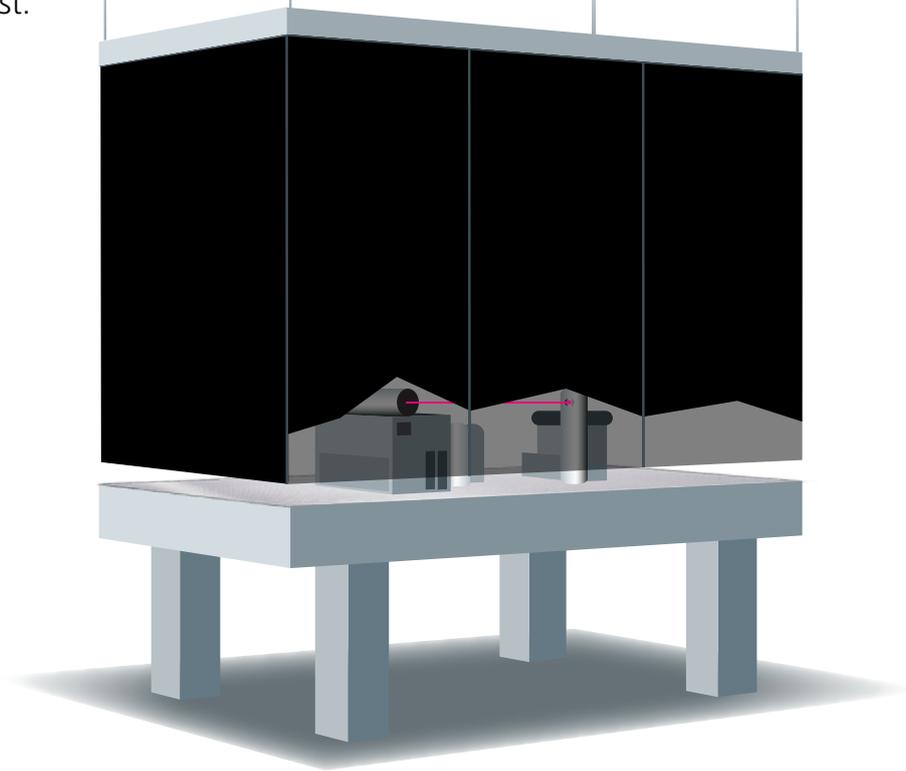
Einfache fahrbare Laserschutzwand in einen Metallrahmen – bespannt mit Laserschutzbereich, festem Metallblech oder Laserschutzglas.
