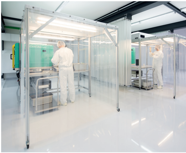
Reinraumzelle „Soft wall“ in der Spritzgussfertigung
