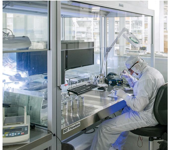
men, mit denen Wafer hergestellt werden. Hierfür sind sogenannte Aktuatoren erforderlich, die die Struktur der Wafer über kleine Parabolspiegel so stark verkleinern, bis die gewünschten Leiterbahnstrukturen im Größenbereich von 18 Nanometern entstehen. Diese Teile werden später im Ultrahochvakuum betrieben, wo selbst winzigste Verunreinigungen auf der Oberfläche oder minimale Ausgasungen zu Ausfällen führen würden.
