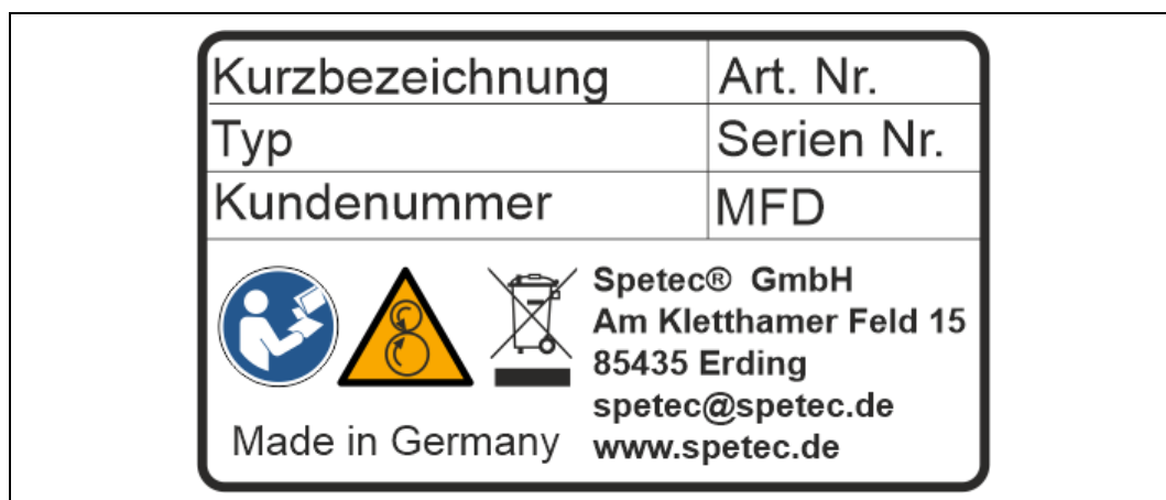
Abbildung 4: Beispiel Typenschild Spritzenpumpe
