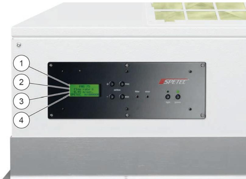
Abb. 3: LCD-Display, vierzeilig
