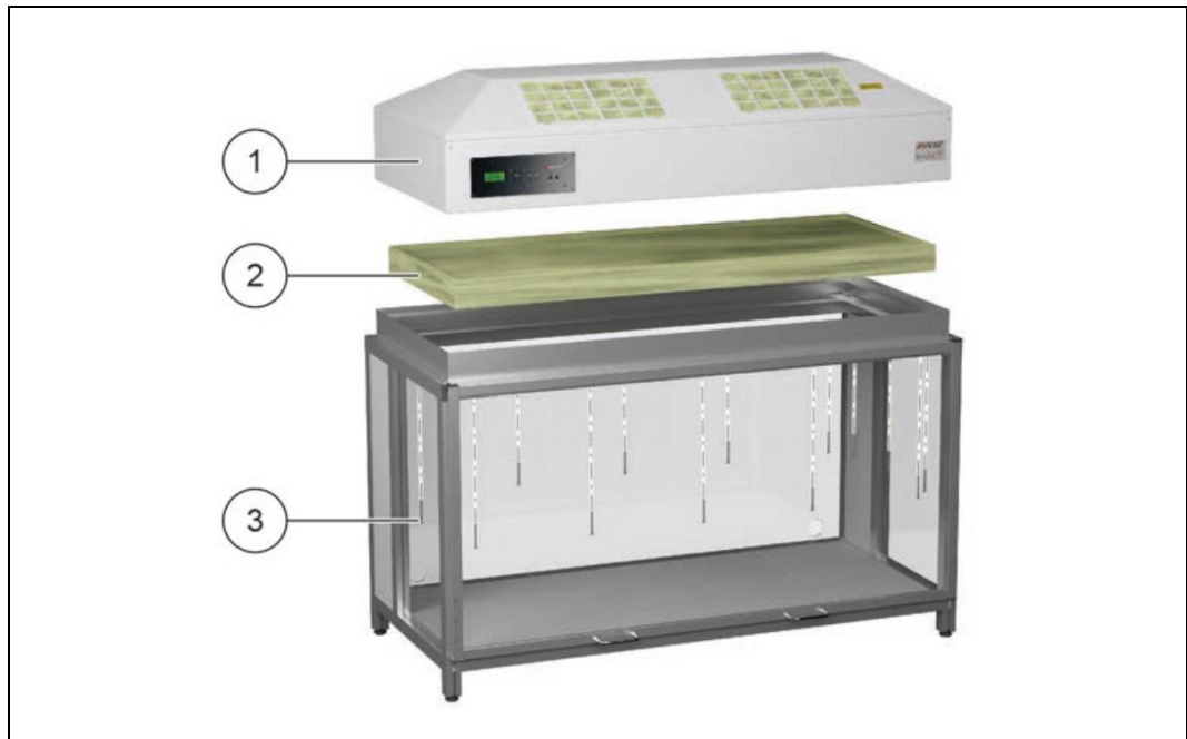
Abbildung 39: Wechsel des Hauptfilters bei Standgeräten
