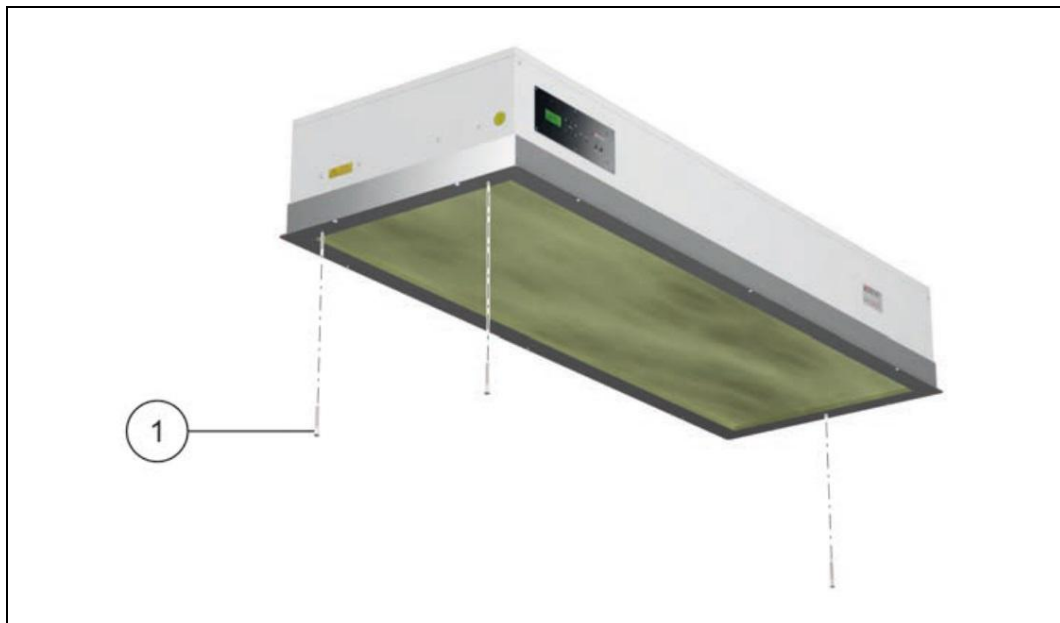
Abbildung 40: Wechsel des Hauptfilters bei Reinraumzellen / abgehängten Laminar Flow Modulen - 1
