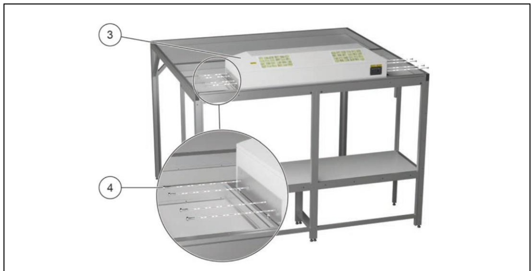
Abbildung 22: FMS-Serie SuSi von der Unterseite montieren - 2
