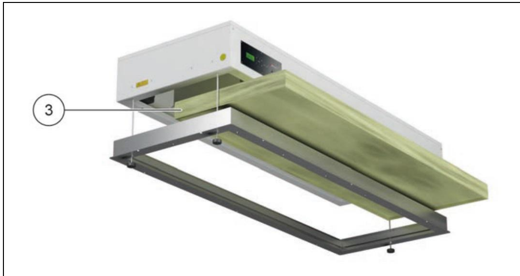
Abbildung 42: Wechsel des Hauptfilters bei Reinraumzellen / abgehängten Laminar Flow Modulen - 3
