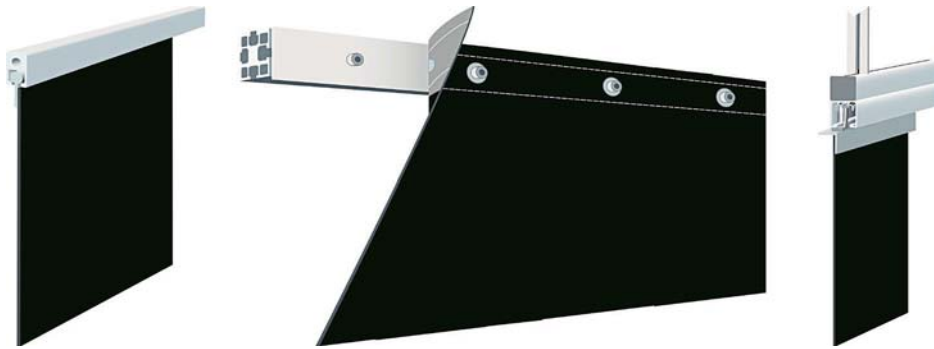
Montageausführungen für Laserschutzvorhänge (Keder-, Klettband- und Schiebeyesystem)
