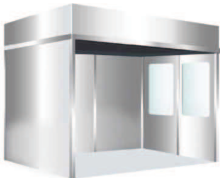
Die Module einer begehbaren Einhausung sorgen für laminare Reinluftzufuhr. Sind im Innern Apparaturen aufgestellt, empfiehlt sich ein Reinluftstrom mit geringer Turbulenz, um einen vollständigen Luftaustausch zu gewährleisten. Bilder: Spetec
